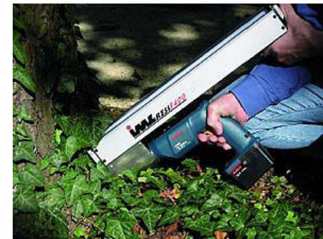
Abb.: Resistograph zur Bestimmung der Holzdichte; eine Bohrnadel wird in den Holzkörper getrieben. Die dabei auftretenden Bohrwiderstände werden kontinuierlich aufgezeichnet. Sie geben Aufschluss über die Holzbeschaffenheit (Foto: IML).
